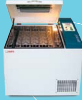
ÇALKALAMALI SOĞUTMALI İNKÜBATÖR ► 10/60 °C ► 20-300 Rpm. ► Çift Dijital Ekran ► 115-216 Lt. Seçeneği
